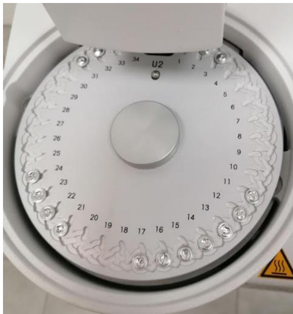
Slika 17: Avtomatični podajalnik vzorcev za DSC analizo; Mettler Toledo DSC 2 Star System
