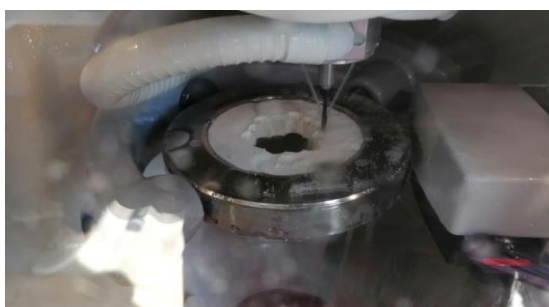
Slika 11: Rezkanje preizkušancev za strižni in DMA preizkus
