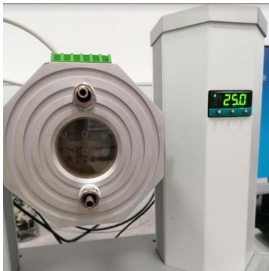
Slika 18: Dinamični mehanski analizator (Perkin Elmer DMA 8000)
