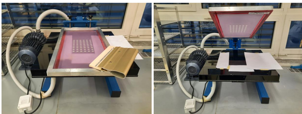
Slika 12: Miza za sitotisk ima možnost prisesavanja tiskovne podlage in za pritrditev tiskarskega sita
