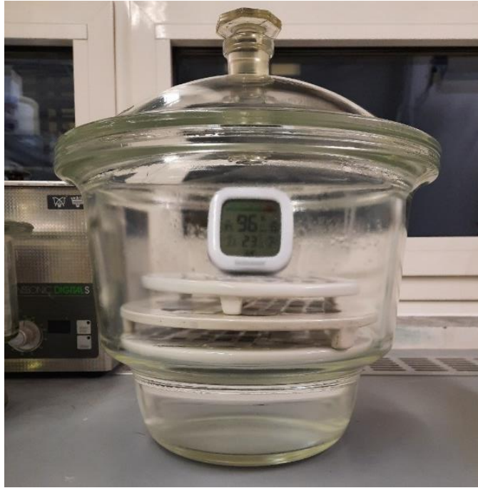
Slika 17: Vzorci v eksikatorju, izpostavljeni 96-odstotni vlažnosti
