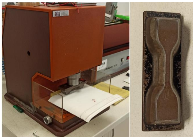
Slika 13: Aparatura za izsek testnih epruvet (levo) in model za izsekovanje vzorcev (desno)
