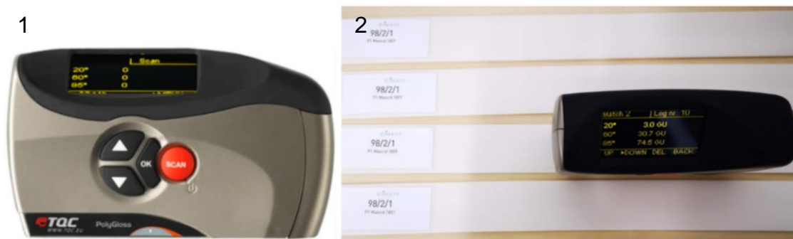
Slika 19: Merilec sijaja (1) in meritev sijaja na PVC profilu (2)
