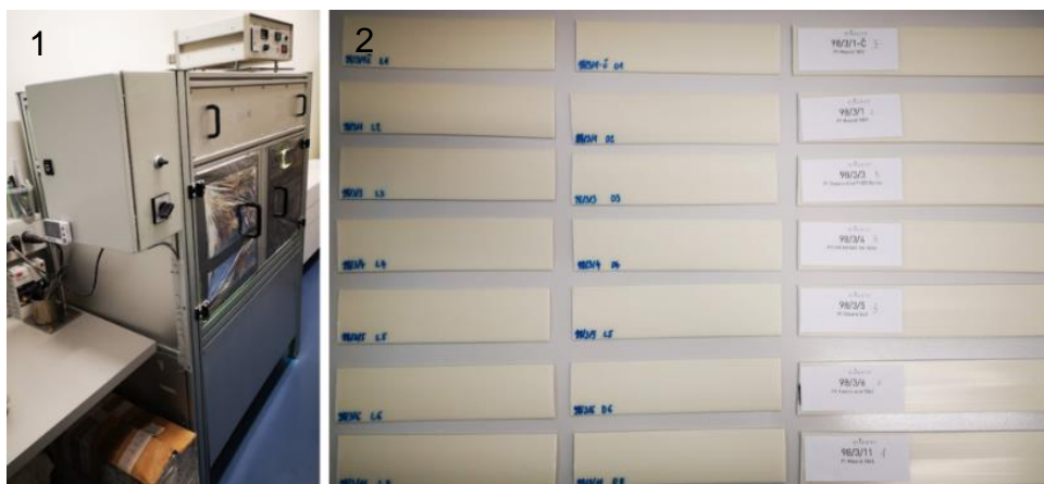
Slika 12: UV komora (1) in degradirani vzorci (2)
