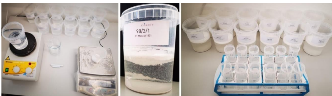
Slika 13: Postopek testiranja stopnje površinske modifikacije kalcijevega karbonata
