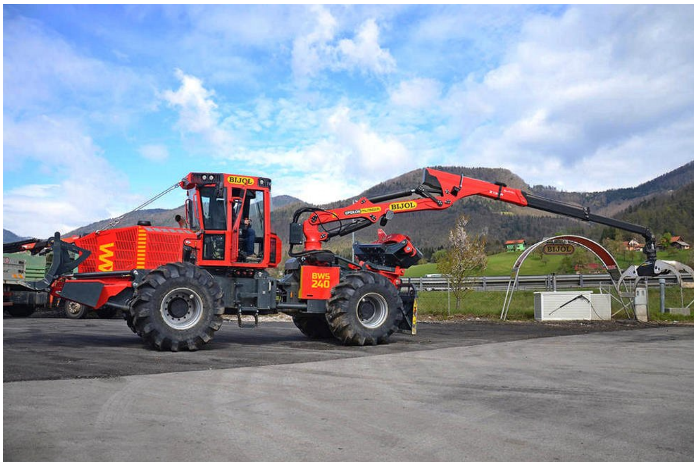
Slika 2: gozdarski zgibnik BWS 240 z iztegnjeno nakladalno roko
