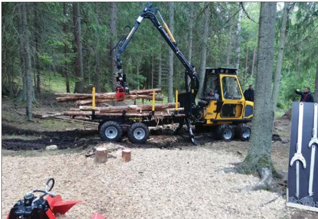
Slika 1: Manjši stroj za izvoz lesa s procesorsko glavo (harwarder) (foto: D. Južnič, B. Cerjak)
