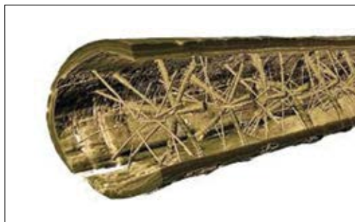
Slika 4: Primer CT-slike sortimenta stroja CT Log proizvajalca Microtec; naprava lahko poskenira do 180 tekočih metrov hlodovine na minuto (vir slike https://microtec.eu ).
