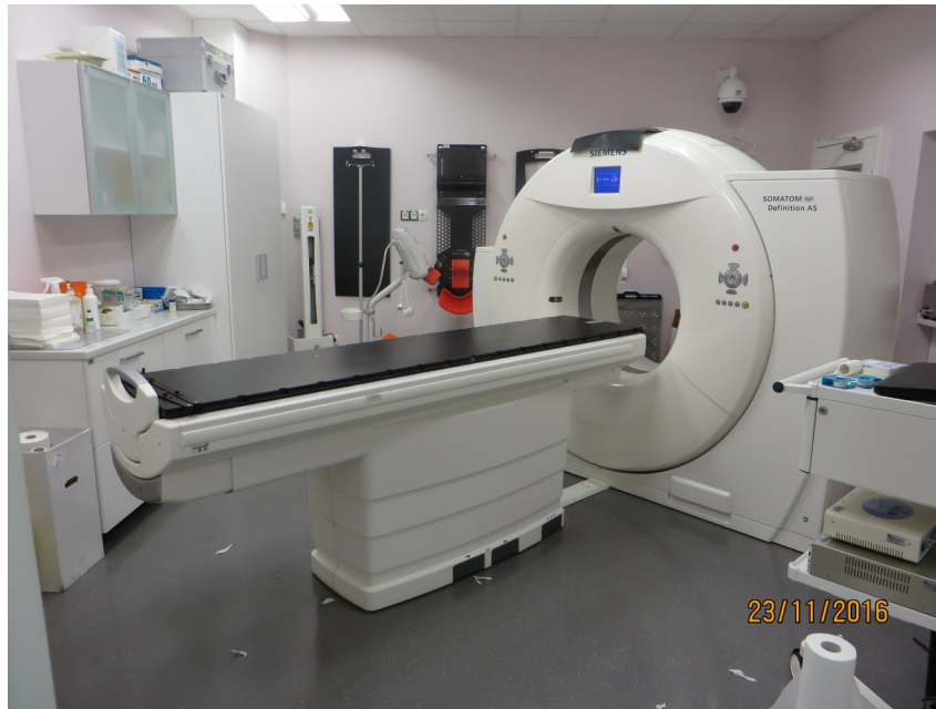
Slika 5. Simulator - CT aparat, ki omogoča, da se področje, ki ga bomo obsevali, prikaže v vrsti prečnih presekov, ki so med seboj oddaljeni 3-5 mm.
