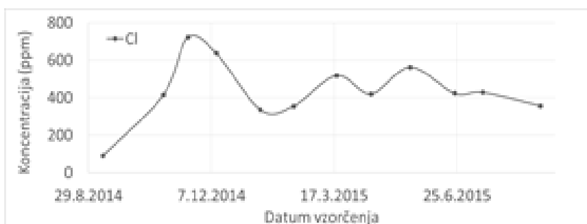
Slika 1: Povprečne koncentracije klora v AI-AIII odsluženem lesu Slovenskega reciklažnega podjetja (S1) skozi eno leto vzorčenja. Vzorci grobe frakcije (zgoraj), Vzorci fine frakcije (spodaj).
