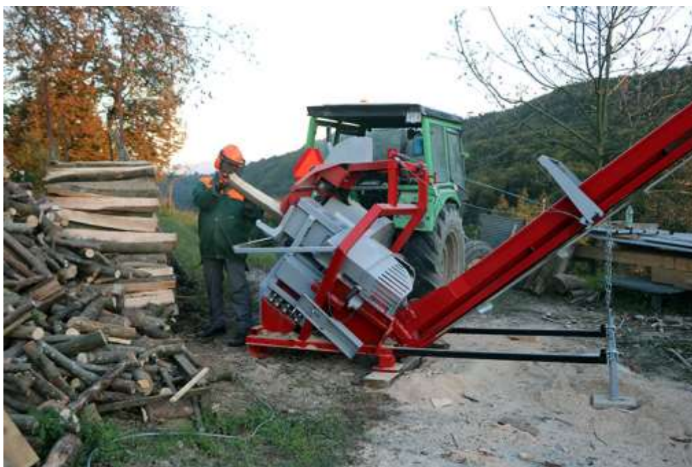
Slika 1: Prevesna krožna žaga z vodoravnim žagalnim koritom (foto: Marjan Dolenšek).
