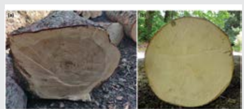
Slika 4: Hlod jelke z (a) mokrim srcem in brez mokrega srca (foto: L. Krajnc in P. Prisljan)
