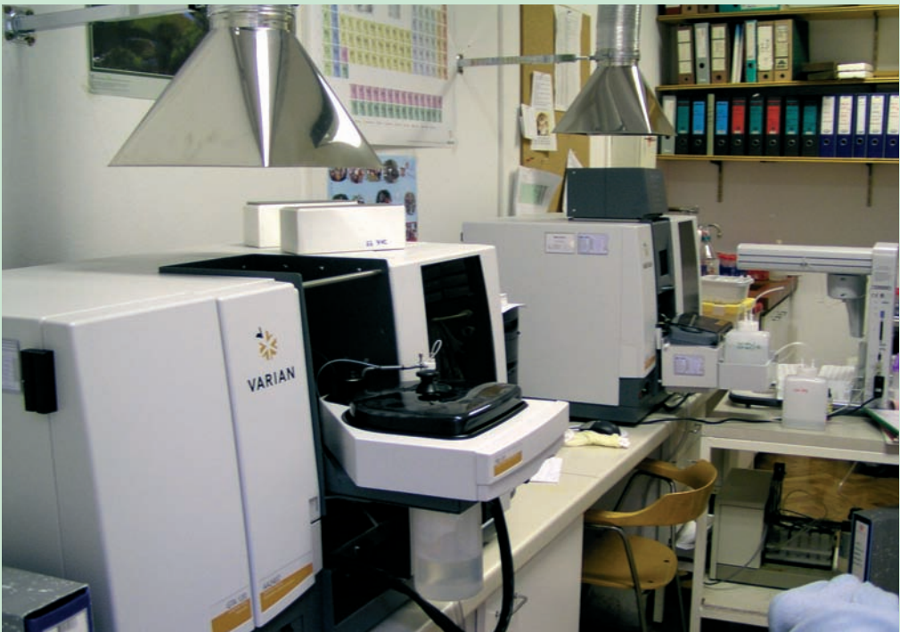
Slika 8: Atomski absorpcijski spektrometer za določevanje vsebnosti hranil in težkih kovin v tleh (foto: Daniel Žlindra)
