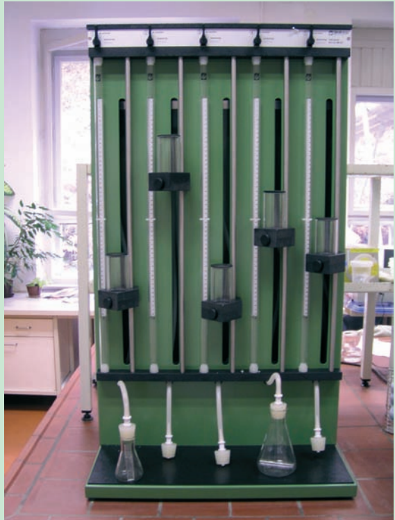
Slika 9: Kalcimeter za laboratorijsko določevanje karbonatov v tleh (foto: Daniel Žlindra)
