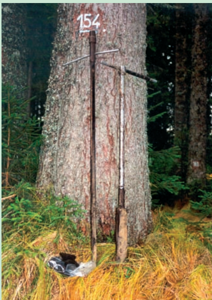
Slika 1 : Žlebasta sonda in sveder z ušesom za preiskave in vzorčenja tal (foto: M. Urbančič)
