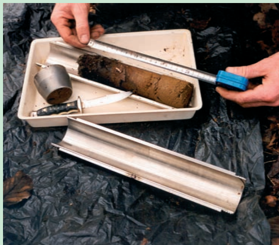
Slika 2: Odvzem talnega vzorca z razkloпно valjasto sondo (foto: M. Urbančič)
