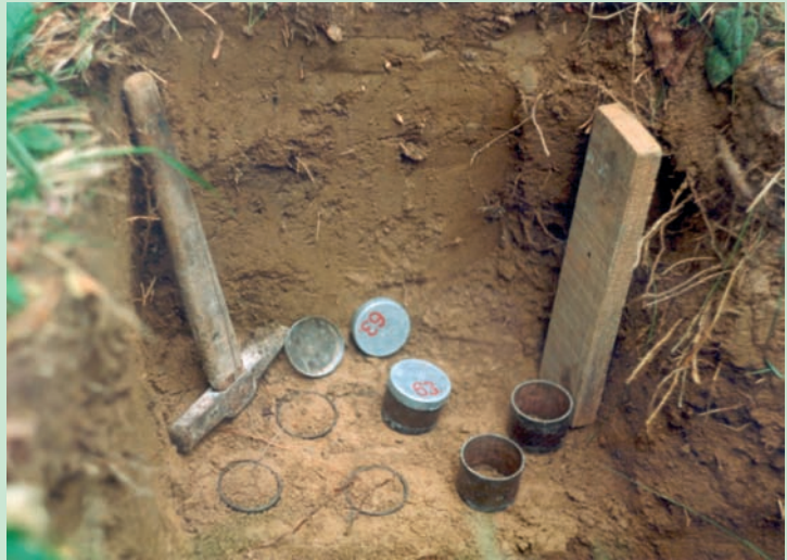
Slika 4: Odvzem talnih vzorcev s Kopeckyjevimi valji (foto: M. Urbančič)
