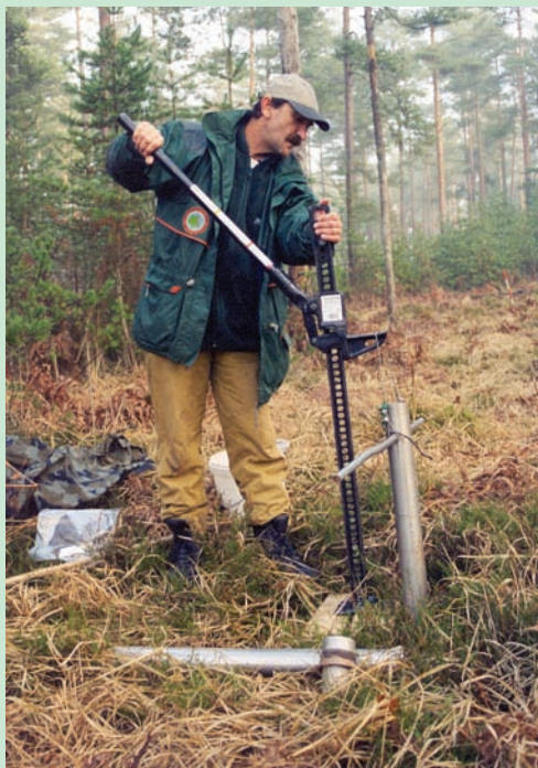
Slika 2: Kvantitativno vzorčenje tal z valjasto sondo (foto: M. Urbančič)
