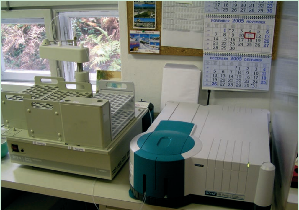
Slika 10: Spektrofotometer za določevanje vsebnosti rastlinam dostopnega in celokupnega fosforja v tleh (foto: Daniel Žlindra)
