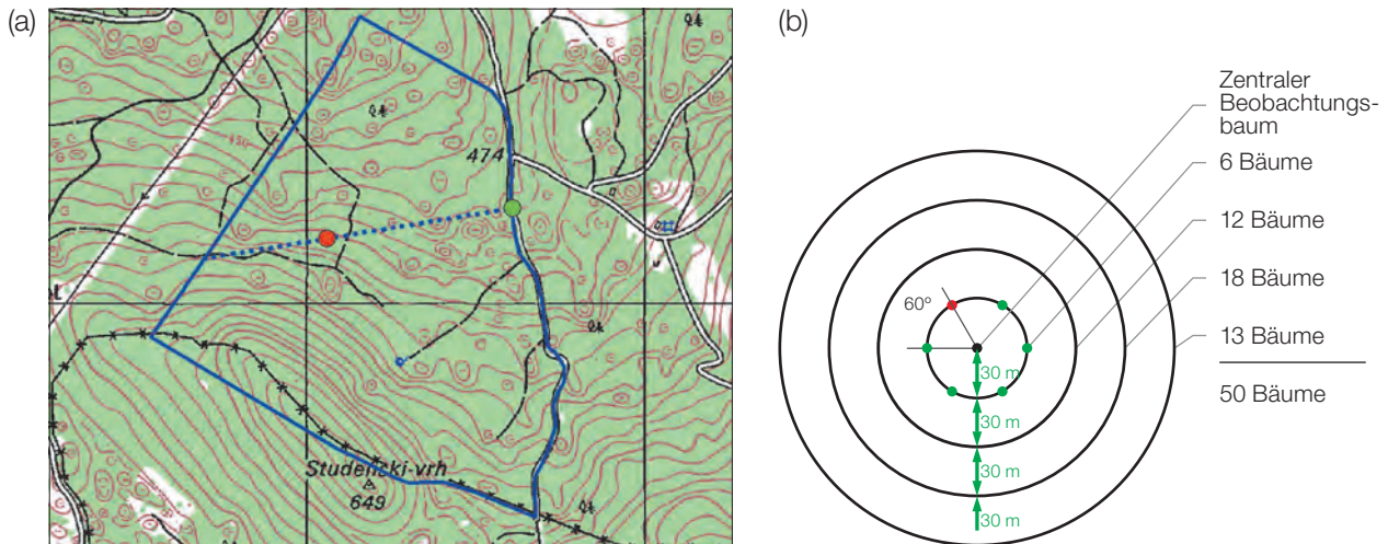
Abbildung 3: Zufallsauswahl des Mittelpunkts der forstgenetischen Monitoringfläche (a); Auswahl von Bäumen in konzentrischen Kreisen mit einem zunehmenden Radius von 30 m um den zuvor ausgewählten zentralen Beobachtungsbaum (b).
