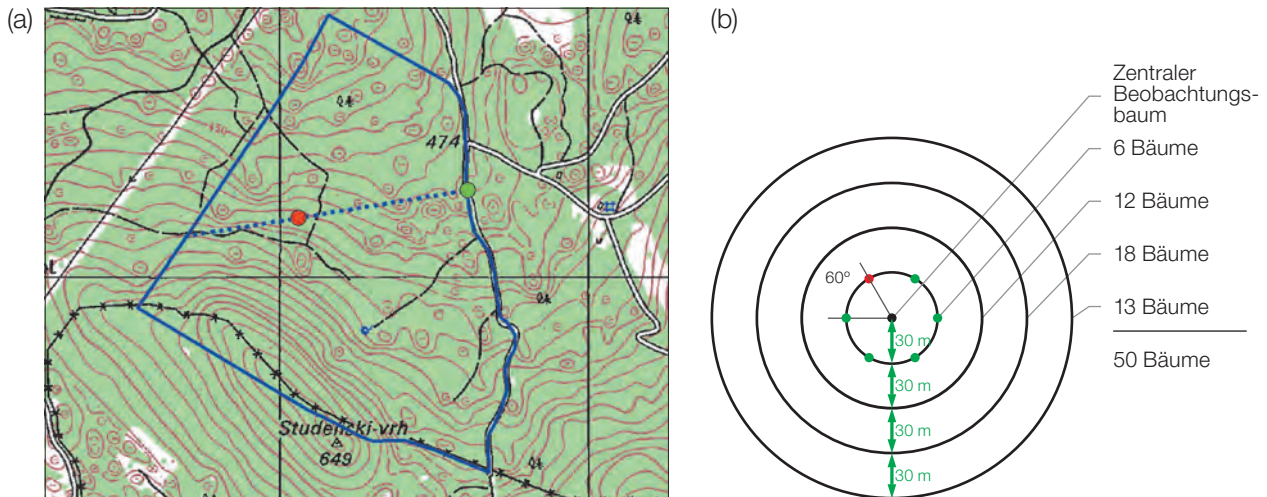
Abbildung 2: Zufällige Auswahl des Mittelpunkts der forstgenetischen Monitoringfläche (a); Auswahl von Bäumen in konzentrischen Kreisen mit einem zunehmenden Radius von 30 m um den zuvor ausgewählten zentralen Beobachtungsbaum (b).
