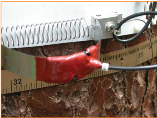
Slika 5: Tračni elektronski dendrometer na deblu jelke.
