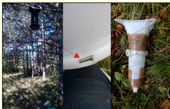
Slika 4: Polomljeni nosilci zbirne posode so lahko posledica vandalizma in/ali naravnih dejavnikov (a, b). Lepilni trak in vrvica sta ključna za uspešno improvizacijo na terenu (c) (foto: P. Smolnikar, GIS)
