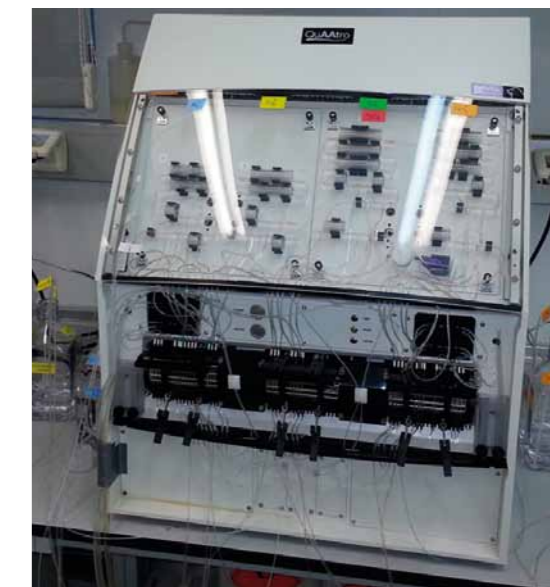
Analizator za segmentno-pretočno analizo (SFA) vzorcev morske vode (Seal Analytical QuAAtro 39) (Foto: arhiv MBP)
