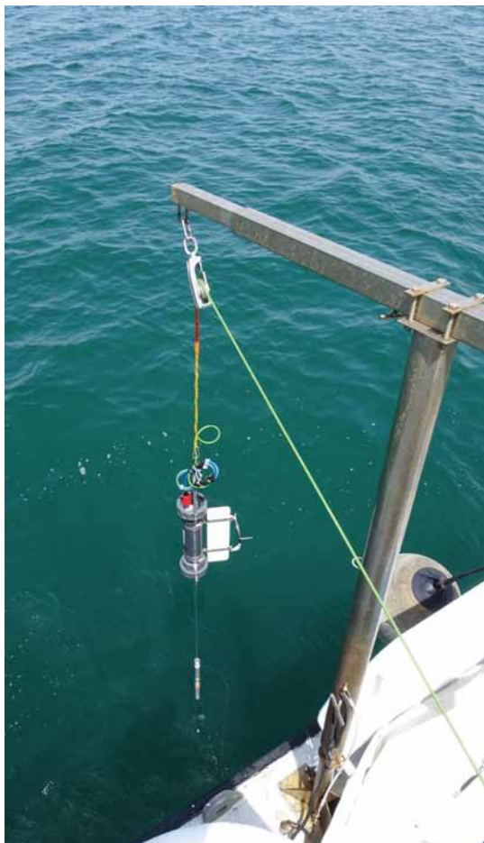
Inovativna metoda za vizualno preiskovanje vodnega stolpa v realnem času (Foto: Matej Marinac)
