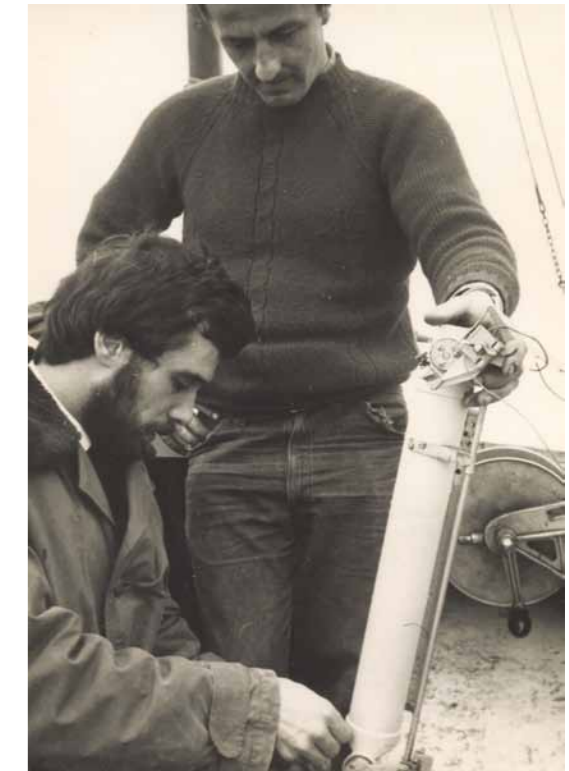
Vzorčenje na PI-50: Nansenova posoda in odčitavanje temperature morja (na sliki: Aleksander Vukovič in Franc Hvala) (Foto: arhiv MBP)
