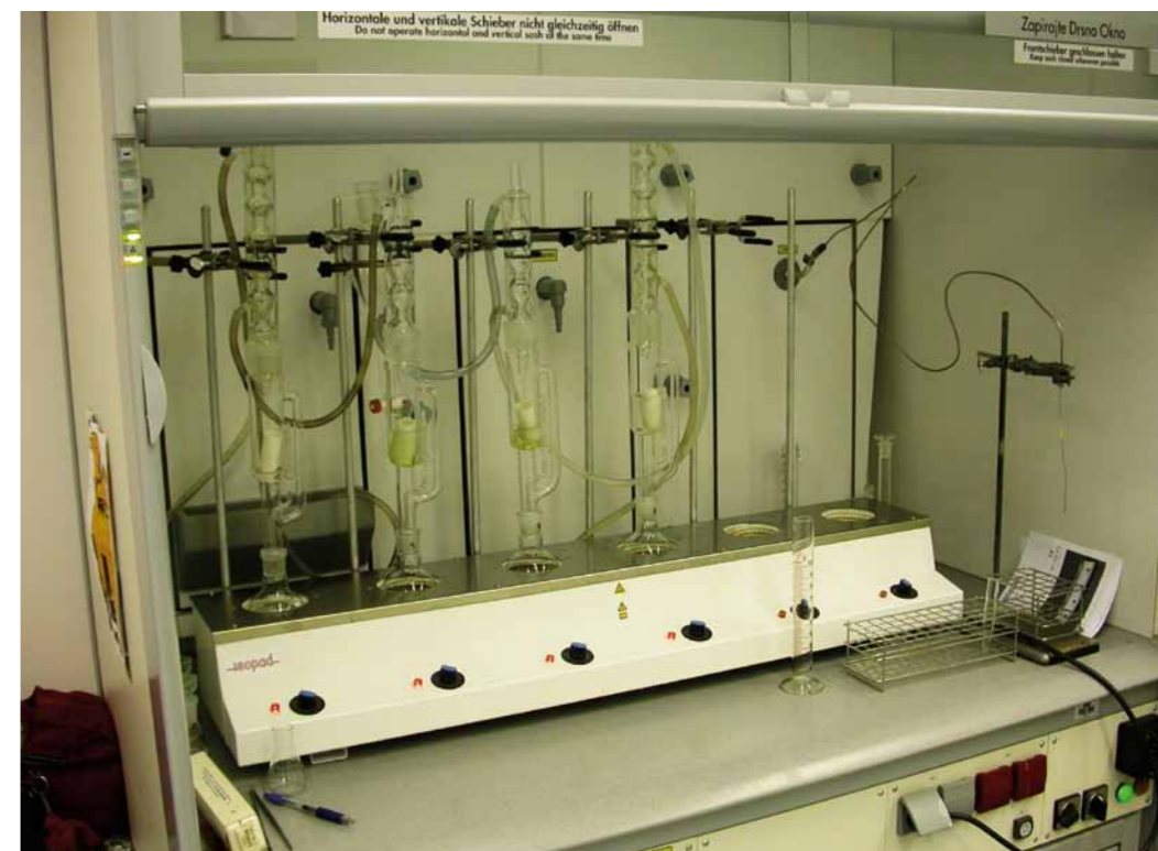
Soxhlet ekstrakcija organskih onesnaževal iz vzorcev morskih sedimentov (Foto: Oliver Bajt)
