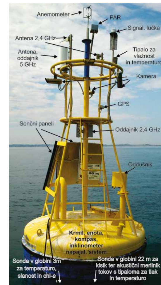
Prikaz merilnih instrumentov na boji Vidi (Foto: Vlado Malačič)
