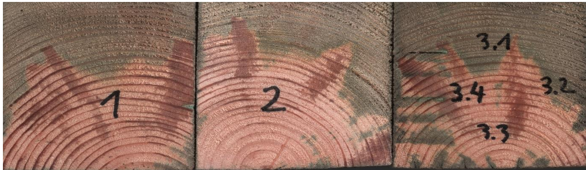
Slika 2: Penetracija biocidnega proizvoda v les (1- neobdelan les, 2 – les sušen v komori s podtlakom, 3 – vrezan les.
