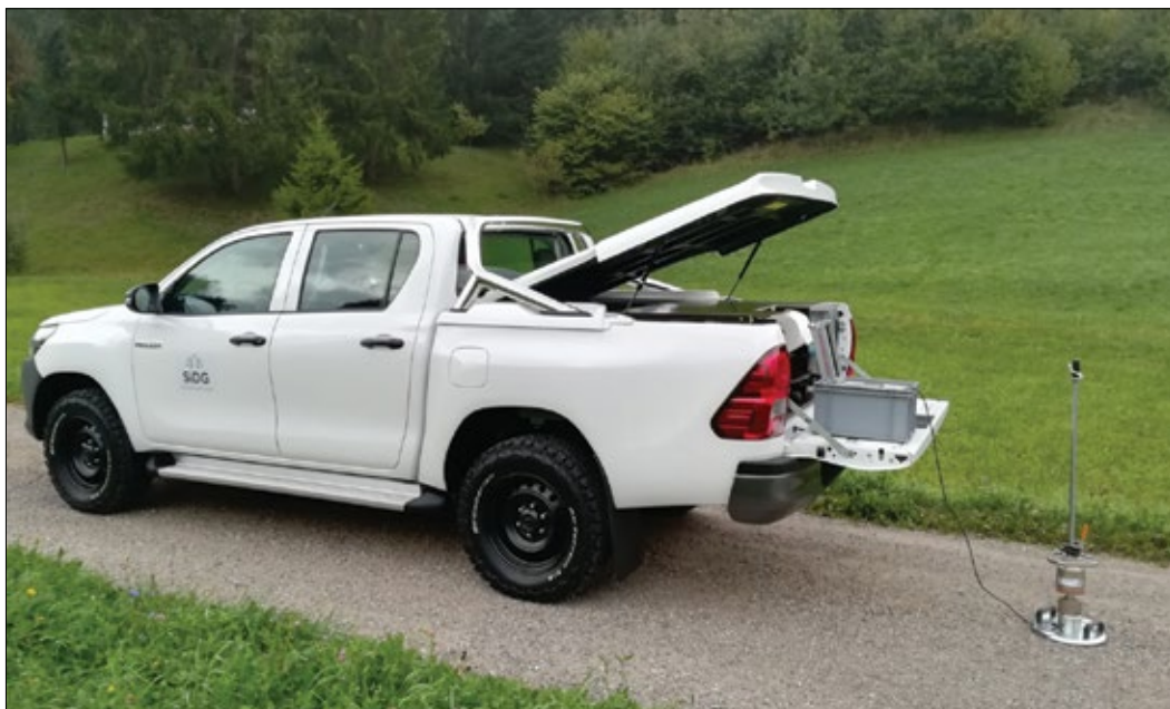
Slika 1: Namensko vozilo SIDG za 'in situ' meritve nosilnosti gozdnih cest (foto: arhiv SiDG)
