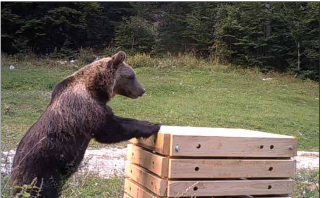
Slika 3: Pred dokončno izdelavo medovarnih kompostnikov, prvič zasnovanih in projektiranih v projektu LIFE DINALP BEAR, smo prototip dodobra stestirali v naravnem okolju. (foto: Arhiv projekta LIFE DINALP BEAR)
