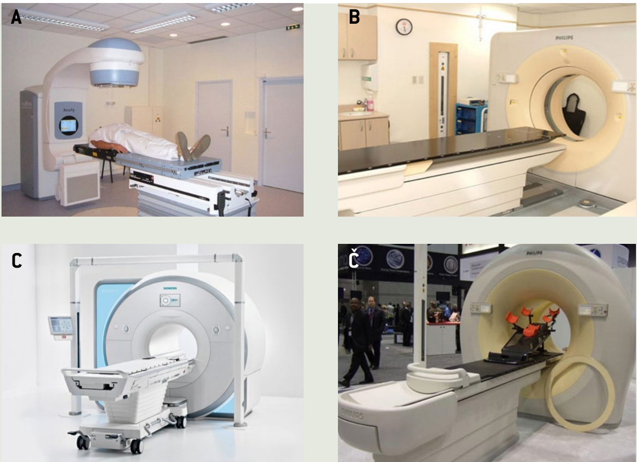
Slika 28. Simulatorji, ki jih uporabljamo v radioterapiji. A – konvencionalni simulator, B – CT simulator, C – MRI simulator, Č – PET-CT simulator.
