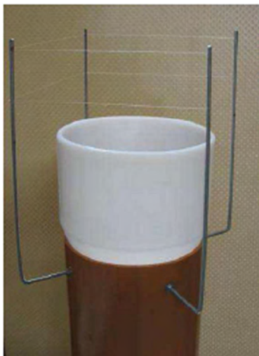
Fotografija 3: končni zgled vzorčevalnika z obročem proti ptičem (foto: D. Žlindra)
