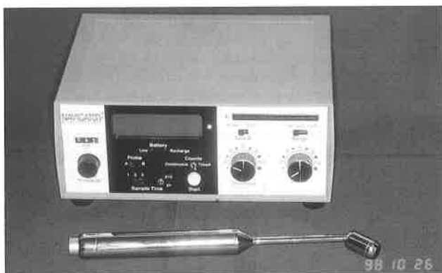
Slika 1. Sonda in aparat za intraoperativno merjenje radioaktivnosti
